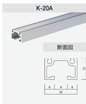
K-20A 取付は天井面、壁面兼用の後付ピック チャーレールです。
